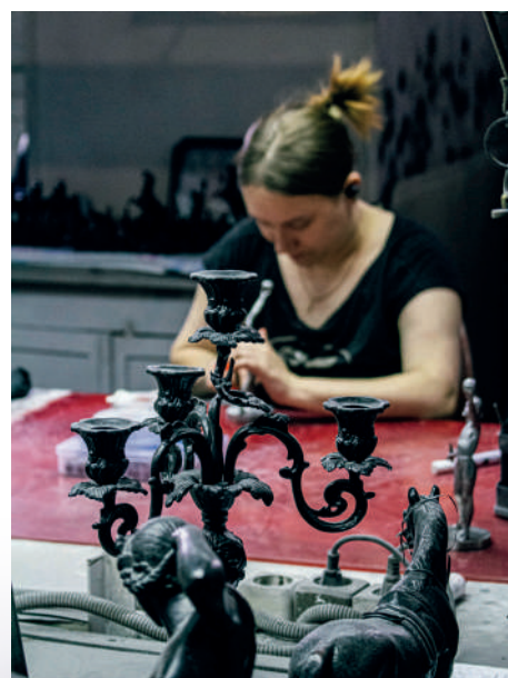
Изделия отшлифовываются и вручную покрываются «голландской сажой»
